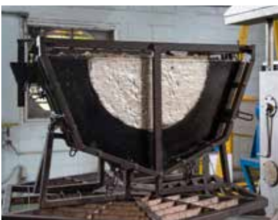
■ Heat Insulation การนำฉนวนใยแก้วมาติดบนผิวด้านนอกแม่พิมพ์โดยใช้แผ่นฉนวนใยแก้ว
