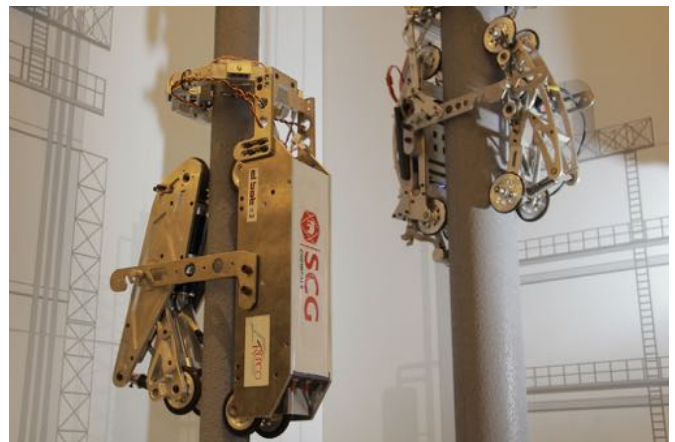
เพื่อยกระดับความปลอดภัยของโรงงานให้อยู่ในระดับโลก เอสซีจี เคมิคอลส์ได้คิดค้นนวัตกรรมหุ่นยนต์ตรวจสอบที่ชื่อว่า ซี-บอท (Ci-Bot) เพื่อใช้ตรวจสอบสภาพของท่อภายในเตาโรงงานปิโตรเคมีให้มีความปลอดภัยและลดความเสี่ยงของผู้ปฏิบัติงานที่เข้าไปตรวจสอบสภาพท่อ
