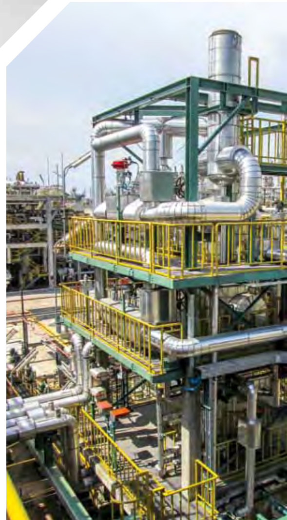
Steam Flash Drum อุปกรณ์ที่ใช้ในการผลิตไอน้ำ
