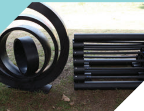
ท่อพีวี 100 เพื่อปลา เพื่อชุมชน PE 100 pipes for the fishes and the community
