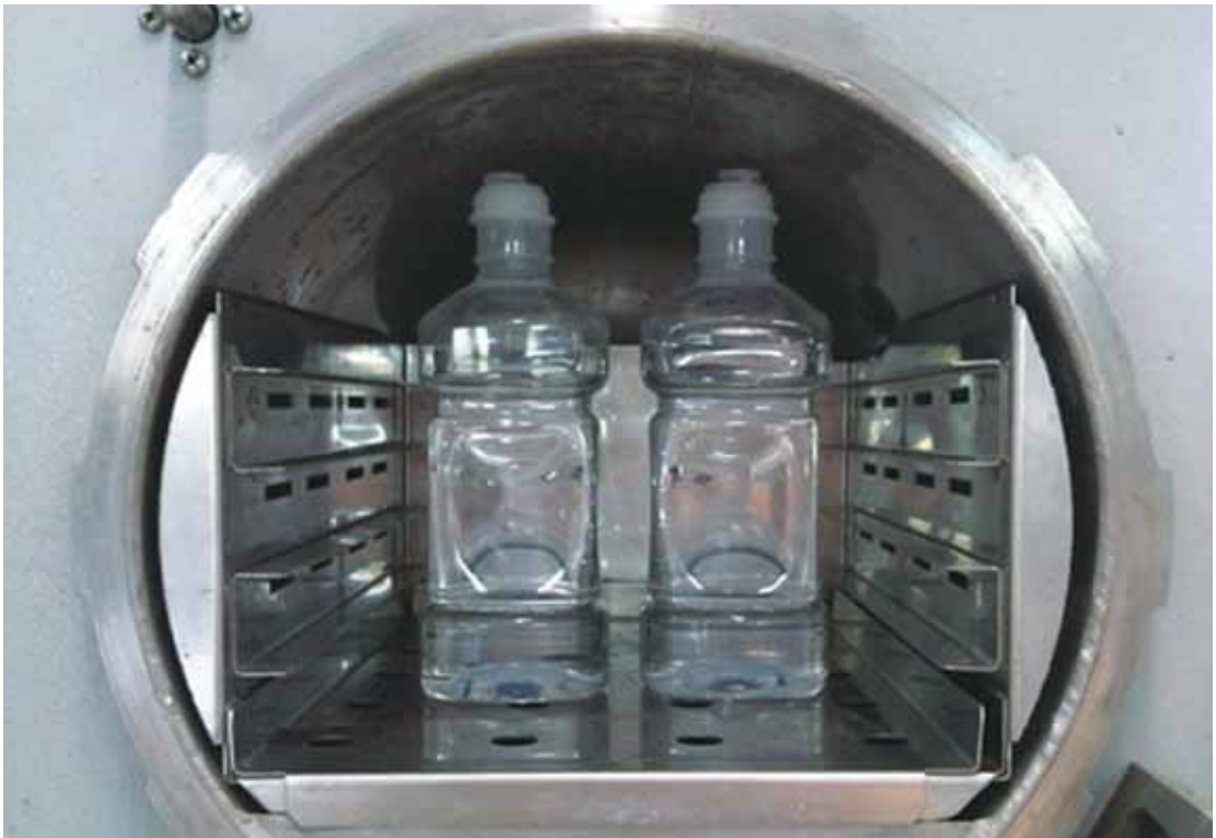
ขวดปลอดเชื้อ ผลิตจากวัสดุโพลีโพรพิลีน (PP) ที่ทนความร้อนและทนทานต่อการฆ่าเชื้อในรูปแบบต่างๆ Sterile bottles made of heat-resistant Polypropylene (PP), with its efficiency and ability to withstand extreme heat and sterilization.
