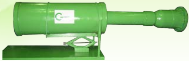
เครื่องลดเสียงจากการทำ Safety Valve Testing จากเดิม ใช้ Silencer > 140 dBA เมื่อทำการติดตั้ง Silencer เสียงลดลงเหลือ 93 dBA This silencer machine reduces the volume expansion of safety valve testing. After installation, the silencer decreases the volume loudness from > 140 dBA to 93 dBA.
