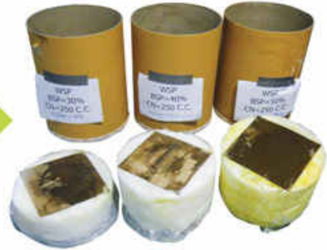
ของเสีย MMA Liquid Waste ที่ทำให้เป็นของแข็ง MMA Solid Polymer
